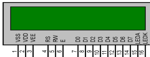
Gambar 2.5 liquid crystal display (LCD) 16x2 Sumber : Eko Utomo, 2014
