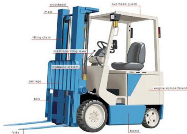
Gambar 2.4 Komponen Forklift
