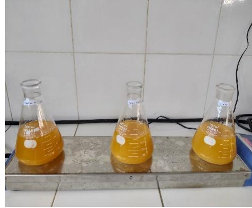
Proses pencucian kering biodiesel menggunakan magnesium silikat
