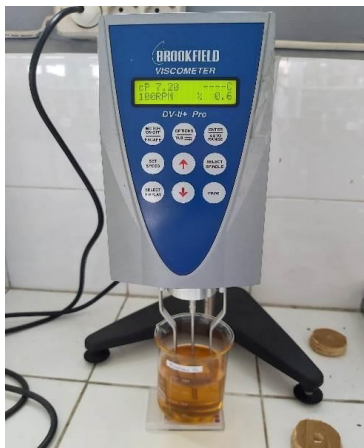
Proses pengukuran viskositas biodiesel menggunakan viscometer brookfield
