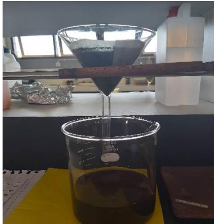
Proses penyaringan dan pencucian karbon sampai pH 7
