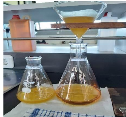
Proses penyaringan/pemisahan magnesium silikat dengan biodiesel
