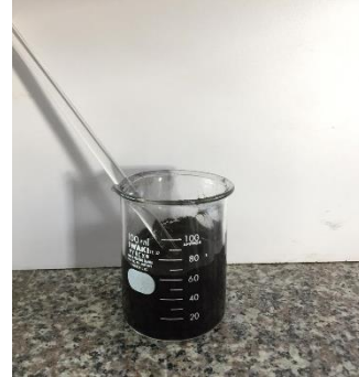
Proses aktivasi karbon dengan larutan NaOH 0.1 N
