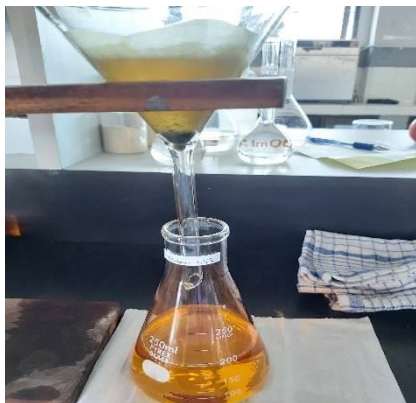
Proses penyaringan/pemisahan karbon aktif dengan biodiesel
