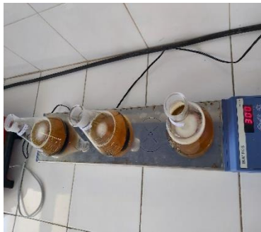
Proses pencucian kering biodiesel menggunakan karbon aktif
