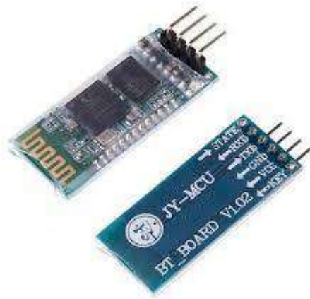
Gambar 2. 7 Bentuk fisik bluetooth HC-06 dan pin out (Wahyuagung,2016)
