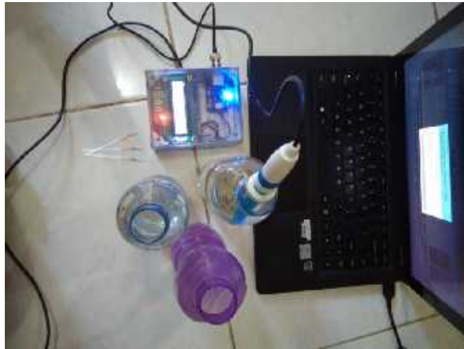
Gambar 4.4 Kalibrasi sensor pH dan perangkat pembanding
