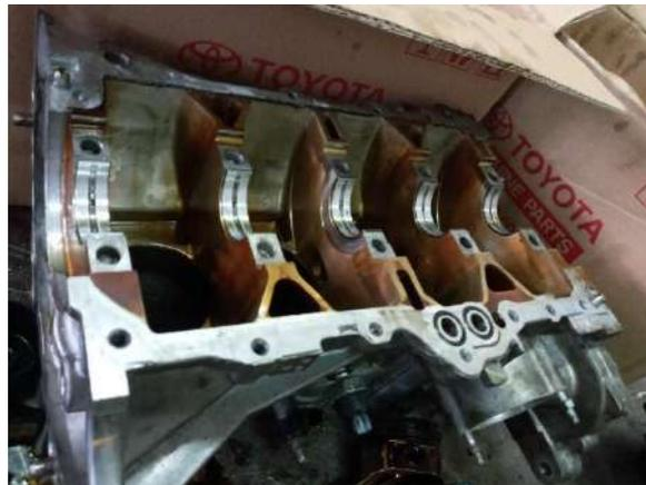
Gambar 3.9 Pembersihan blok silinder
