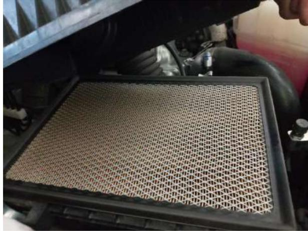
Gambar 3.8 Pengganti filter udara
