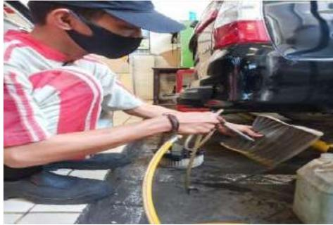
1. Proses pengecekan pada filter udara
