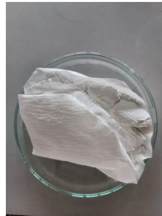
Magnesium silikat setelah di panaskan di dalam oven
