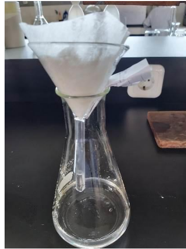
Proses penyaringan dan pencucian magnesium silikat sampai pH 7
