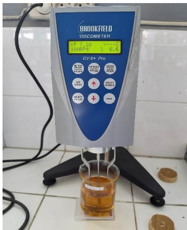
Proses pengukuran viskositas biodiesel menggunakan viscometer brookfield
