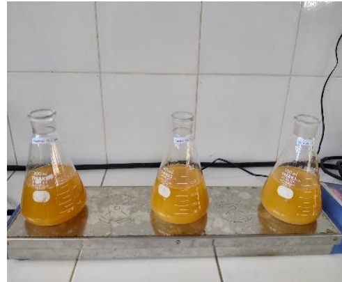
Proses pencucian kering biodiesel menggunakan magnesium silikat
