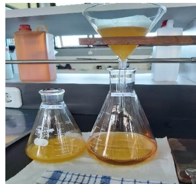
Proses penyaringan/pemisahan magnesium silikat dengan biodiesel
