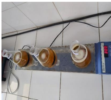
Proses pencucian kering biodiesel menggunakan karbon aktif
