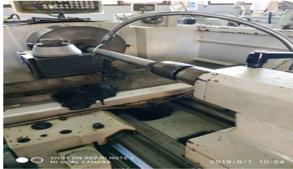
Gambar 3.4 proses membubut poros
