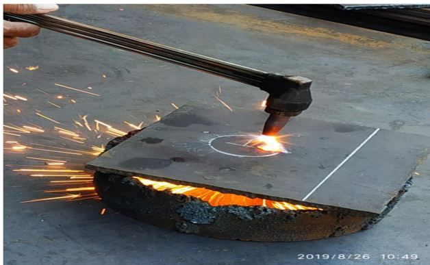
Gambar 3.5 proses melubangi plat dengan brander .
