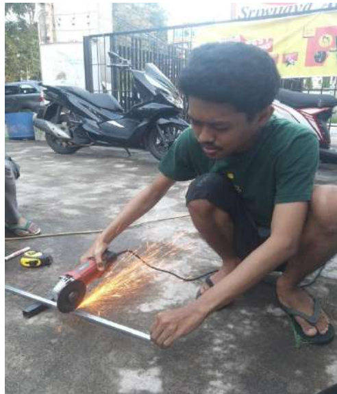
Gambar 5.2 Pemotongan besi rangka mekanik
