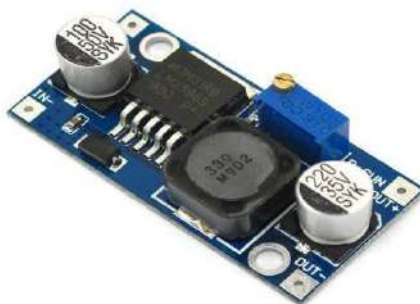
Gambar 2. 6 LM2596S DC-DC step down module ( sumber; handoko, 2016)
