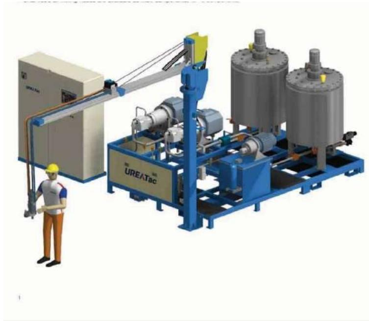
Gambar 3.5. mesin inject PU pintu kulkas sebagai bagian dari line PU foaming pintu kulkas
