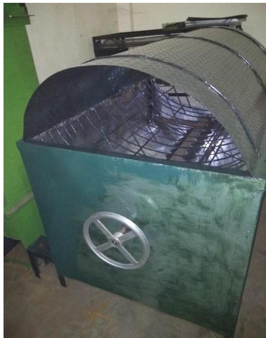
Gambar Mesin perontok buah kelapa sawit
